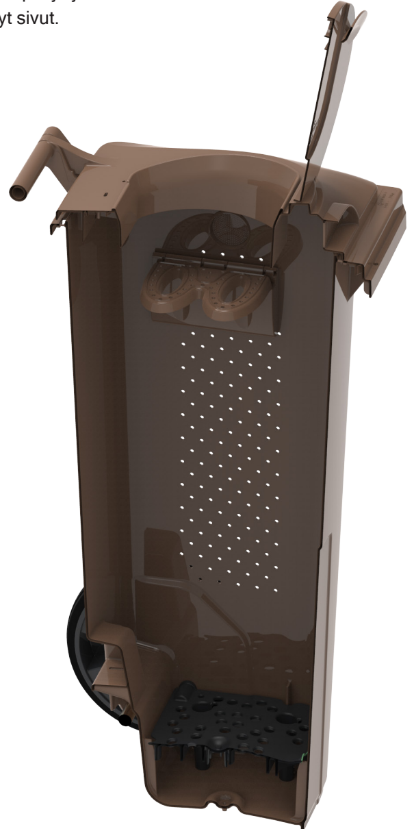
Kumivälitteet vaimentavat kanteen sulkeutumisaääntä ja parantavat astian ilmanvaihtoa.
