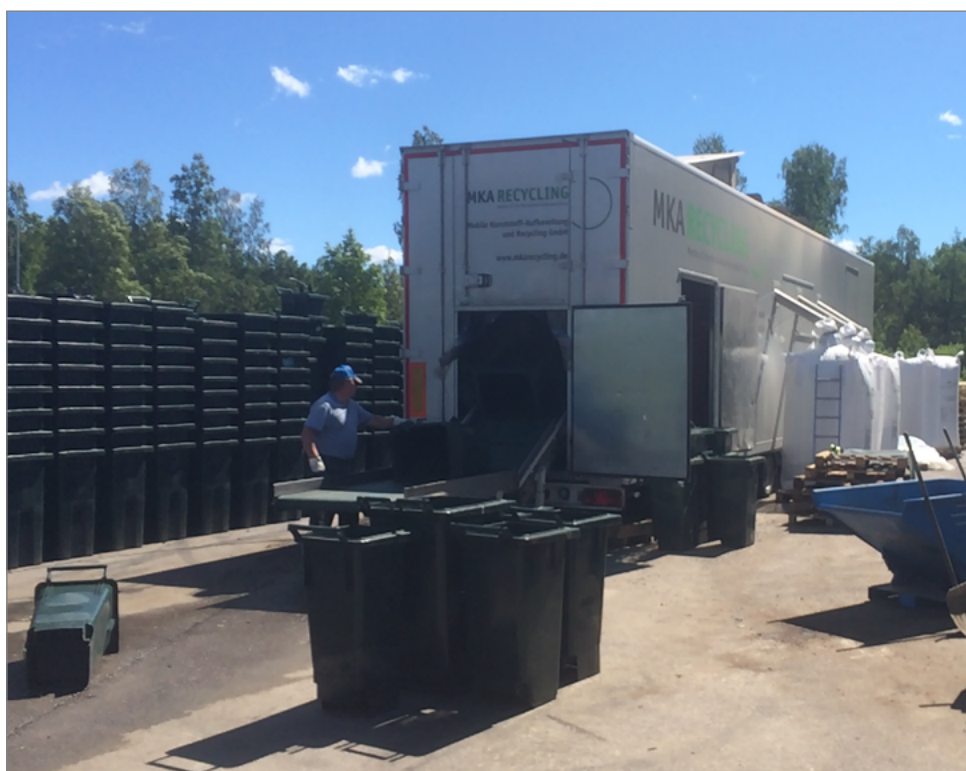
PWS mobiilimurska vanhojen astioiden rakeistamiseen.
